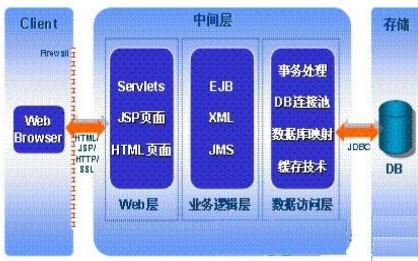
图 2.1 系统整体架构图
